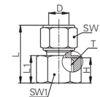
**TKT系列快拧管接头**可广泛用于各种工业领域，连接简单可靠，适用于铜管或其他金属硬管的连接。接头内部铜套、螺母等配件符合DIN3870-3861标准。
