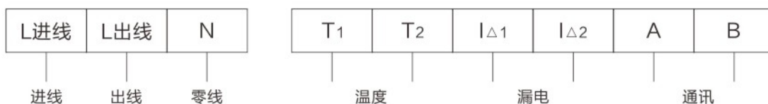
电气防火限流式保护器接线端子图
