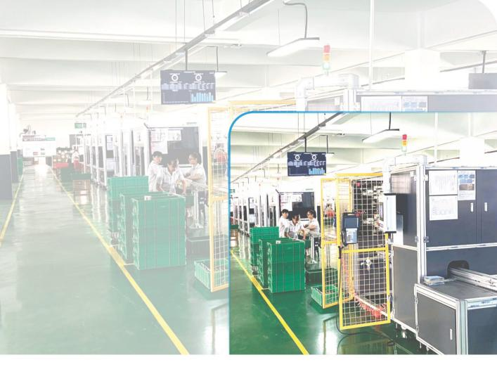
AUTOMATIC CIRCUIT BREAKER (MCB) ASSEMBLY LINE
