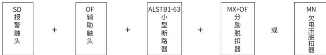
图3 MX+OF分励脱扣附件
